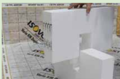
Nosné kříže z EPS 100 x 500 x výška dle volby 200 - 300 mm zajišťují snadné rychlé sesazení.
